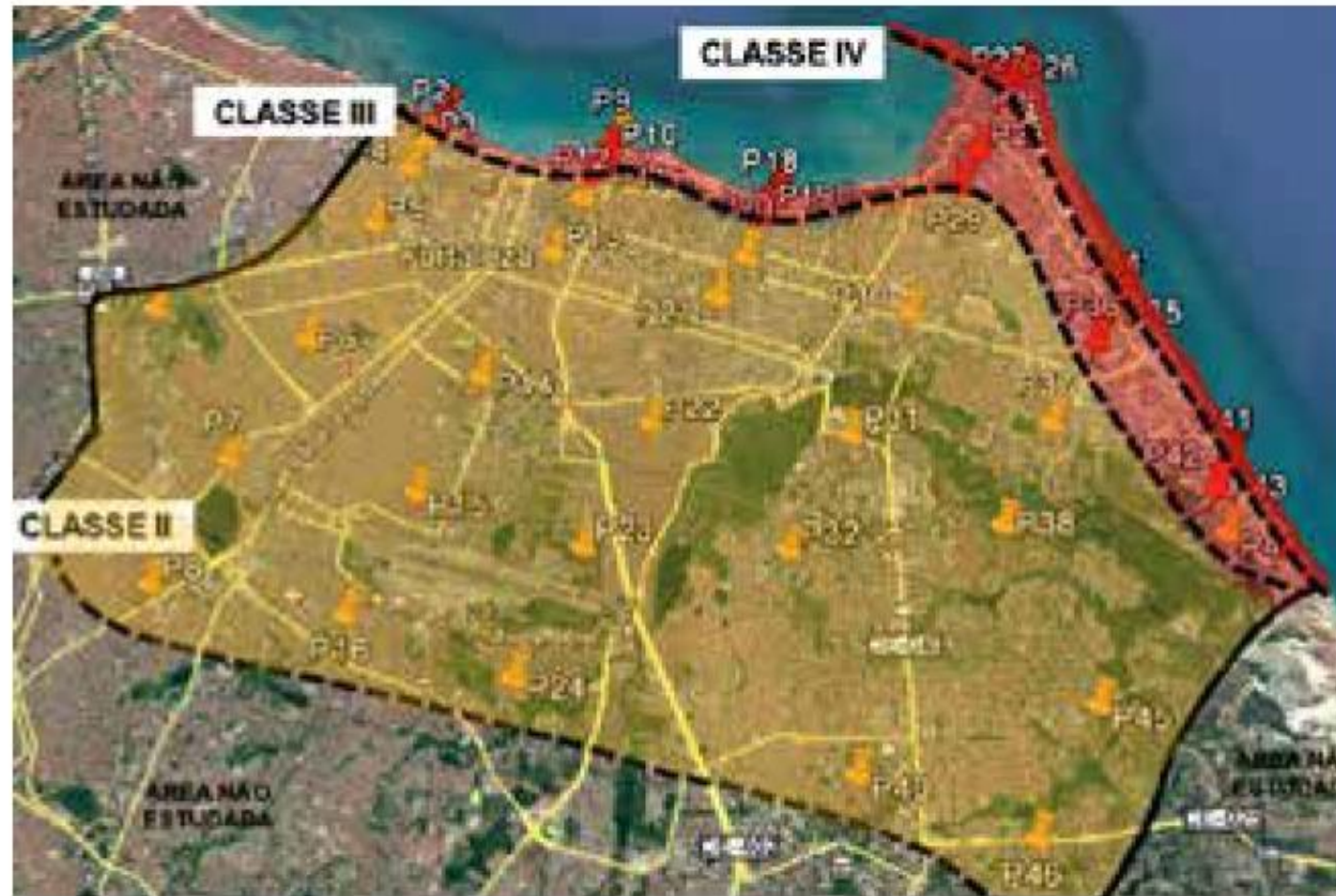
FIGURA 22 - PROPOSTA DE CLASSIFICAÇÃO DAS ZONAS DE AGRESSIVIDADE SEGUNDO A 2ª LEI DE FICK.
