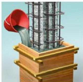
Para grandes espessuras de recomposição, pode-se optar pela aplicação de grautes fluidos tipo **SikaGrout®-250** ou **SikaGrout®** com auxílio de fôrmas de madeira.
